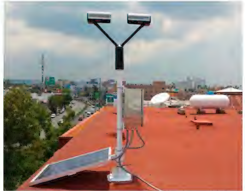
Figura 5. Sistema de medición de lluvia del Observatorio Hidrológico del Instituto de Ingeniería de la UNAM. Fotografía cortesía del Observatorio Hidrológico.
